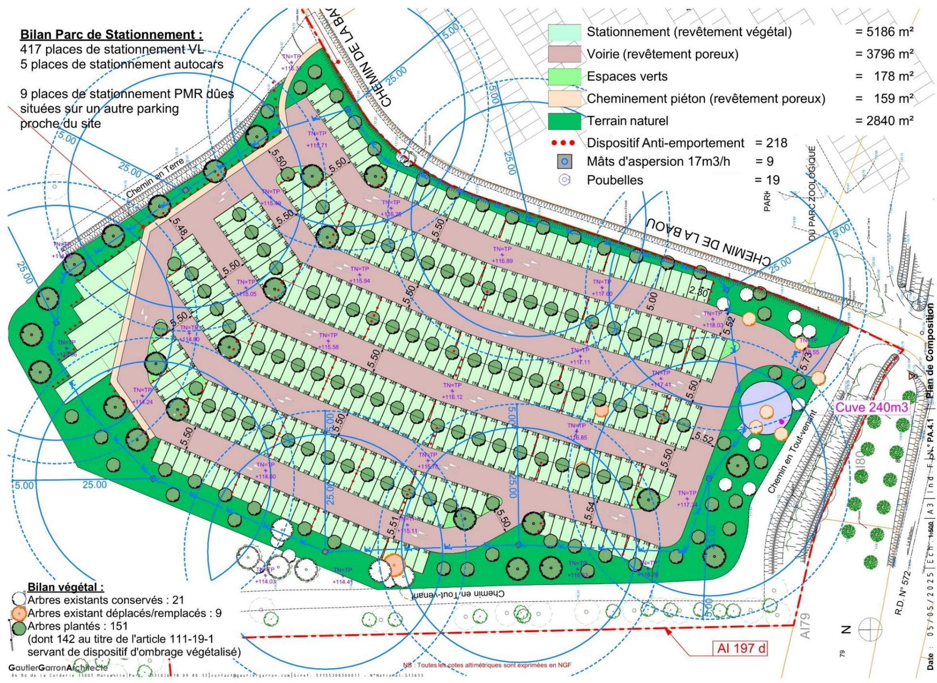
Figure 7 : Plan de masse du projet parking Gouin (Source : Gautier Garron Architecte)
